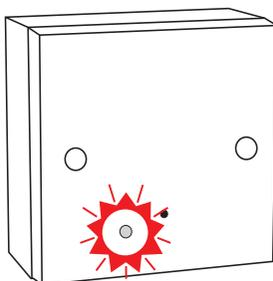
Die LED blinkt für einen Moment schnell auf, wenn das Gerät in den Hauscodierungsmodus schaltet.
