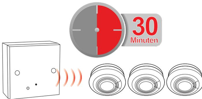
Ab jetzt steht ein Zeitfenster von 30 Minuten für die Vernetzung des Verbindungsmoduls mit den anderen Komponenten des Funksystems zur Verfügung.
