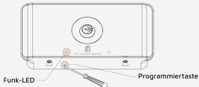
Schieben Sie einen dünnen Schraubenzieher durch die Öffnung und betätigen Sie die Programmiertaste. Halten Sie diese gedrückt bis die blaue Funk-LED leuchtet. Lassen Sie danach los.
